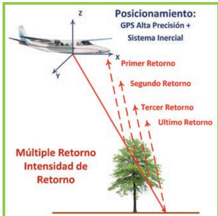
Figura 2. Funcionamiento del sensor LiDAR
