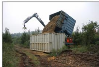
3- Descarga astilla sobre contenedor.
