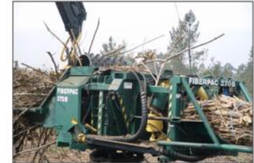
3- Corte de la paca a la longitud deseada.
